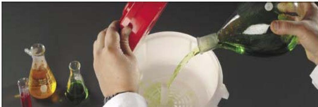
El sistema está patentado y consiste en un embudo con tapa de cierre hermético.
