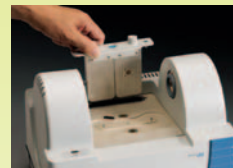
Fácil sustitución del desecante para proporcionar máxima protección al instrumento
