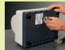
Sustitución de la fuente IR sin abrir el instrumento ni llamar al servicio técnico
