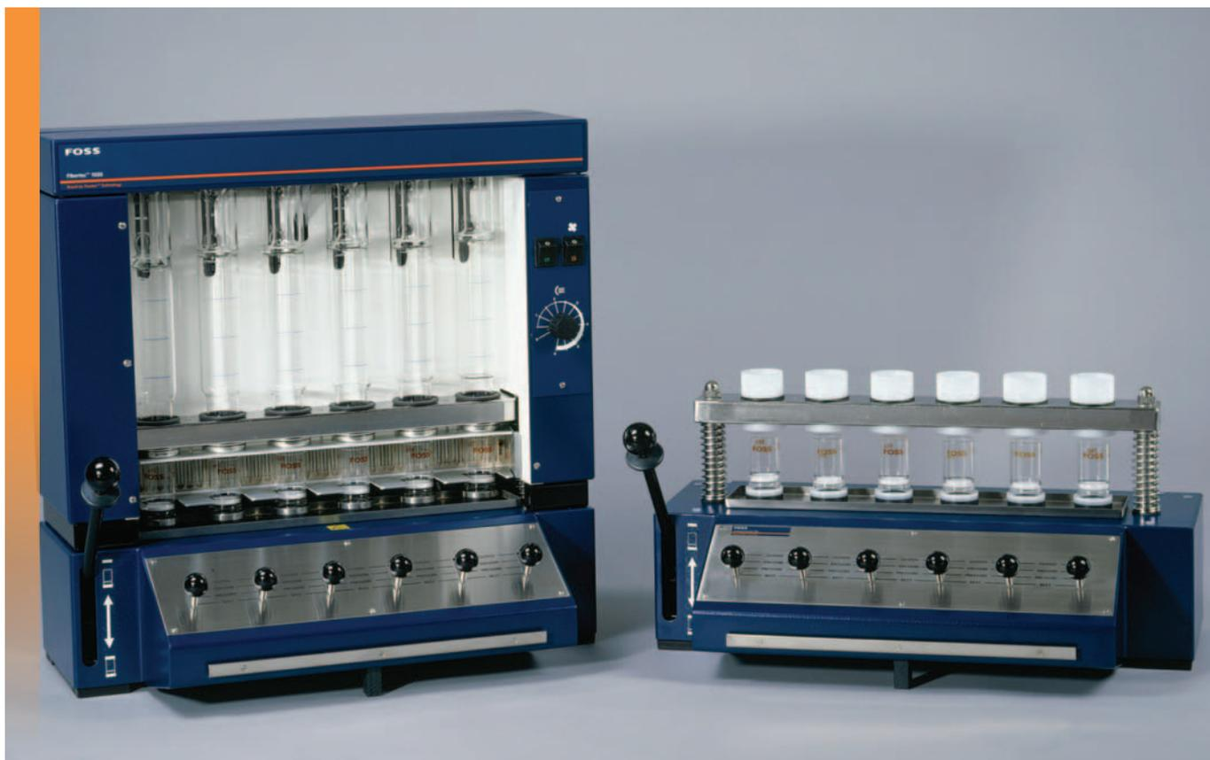
El sistema Fibertec™ M6 consta de unidades de extracción en caliente y en frío para la determinación sencilla de fibra cruda y fibra en detergente y los parámetros relacionados según los métodos de "crisol" de referencia estándar, tales como Weende, van Soest, etc. para su uso en laboratorios.
