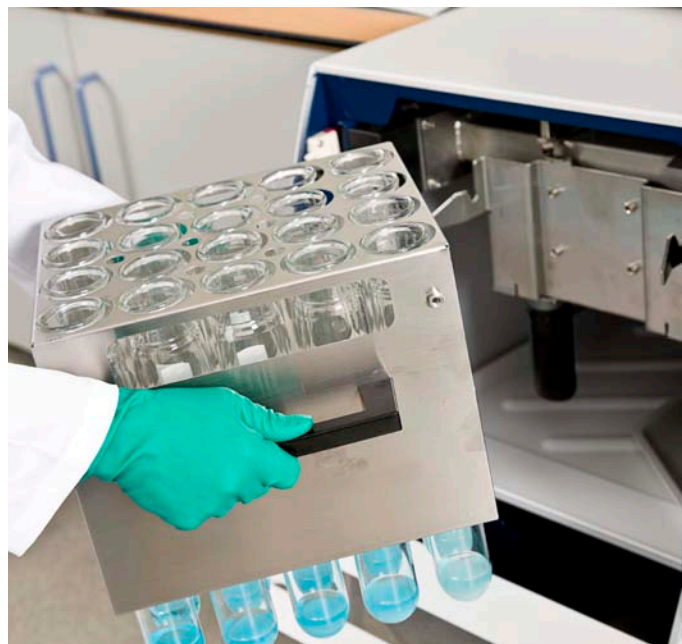
Cargue los portamuestras directamente en el bloque de digestión y el sistema Kjeltec™ realizará un análisis preciso y de forma autónoma durante más de cuatro horas.
