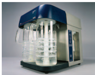
La depuradora neutraliza los humos corrosivos.
