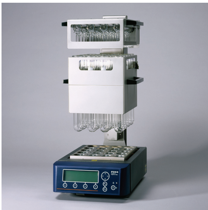
La unidad de elevación evita la manipulación de cargas pesadas.
