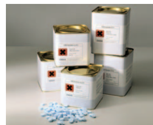
Pastillas catalizadoras Kjeltabs, sal y catalizador en forma de pastilla.
